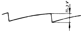
7 Obvod mřížkového vinutí transformátoru TR2
