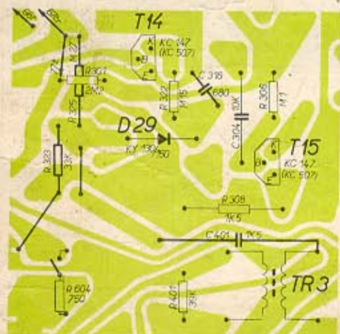
Obr. 19. Mechanická úprava zosilňovača synchron. impulzov
