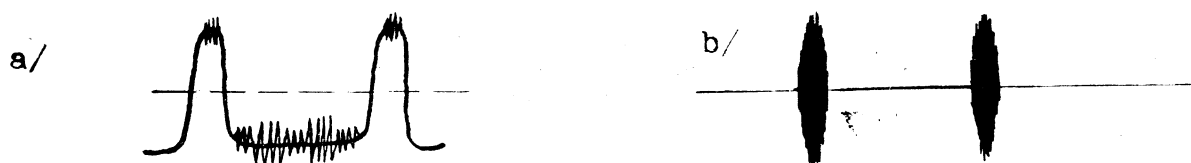
Obr. 7.11 Priebehy napätí kľúčového zosilňovača synchronizačného signálu farieb. a) Na vstupe, b) Na výstupe
